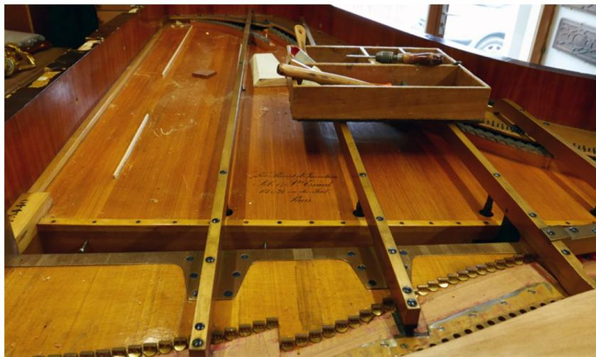
Ci-dessus et ci-dessous : Nous passons à présent au tablage ou réparation de la table d'harmonie. Il s'agit à ce stade de repérer les fentes dans la table, de les ouvrir et de les combler grâce à un élément de bois taillé en biseau, réalisé dans la même essence de bois que la table d'harmonie
