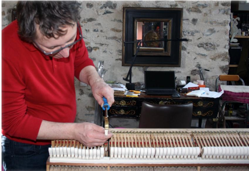
L'harmonisation s'effectue une fois que le fonctionnement de la mécanique est assuré. Nous agissons sur la forme et la tension du feutre de tête de marteau. Ci-dessus, les têtes sont chauffées avec un fer spécial qui permet de « lisser » la fibre du marteau en surface pour un plus bel aspect et une plus grande brillance du timbre.
