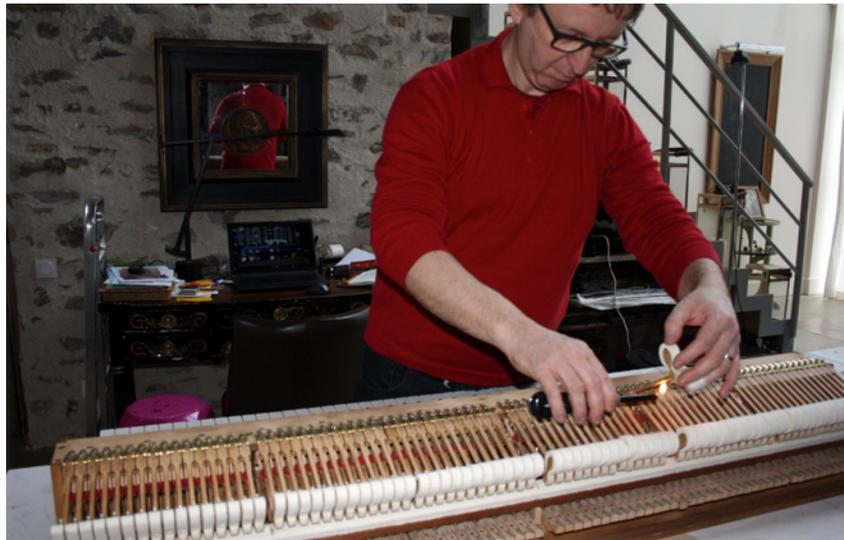
Le réglage de la mécanique commence par le placement des pièces les unes par rapport aux autres. On s'assurera par exemple que les marteaux vont bien frapper les cordes au centre et que les marteaux sont espacés régulièrement entre eux, qu'ils se déplacent bien de manière parallèle, etc... Comme ci-dessus nous agissons entre autres par chauffage du manche de marteau.
