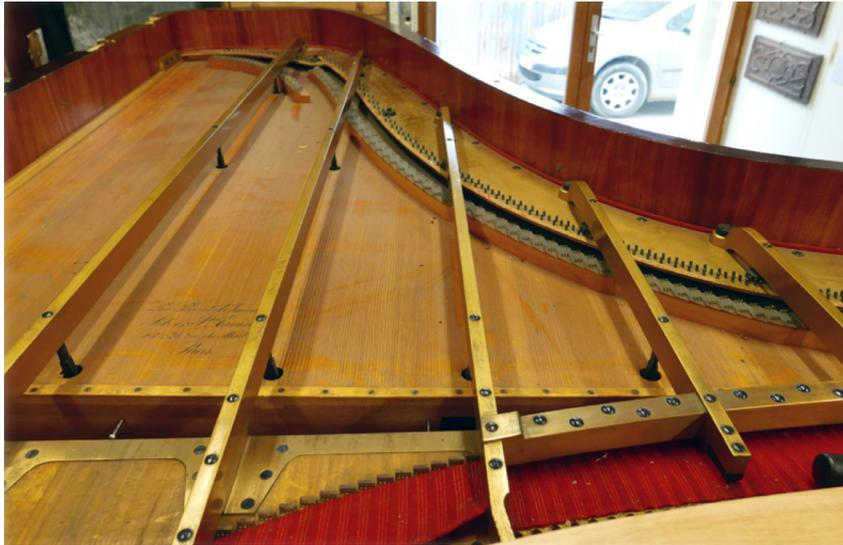
Ci-dessus : La structure débarrassée des cordes. Un bon nettoyage et une inspection poussée sont entrepris.
