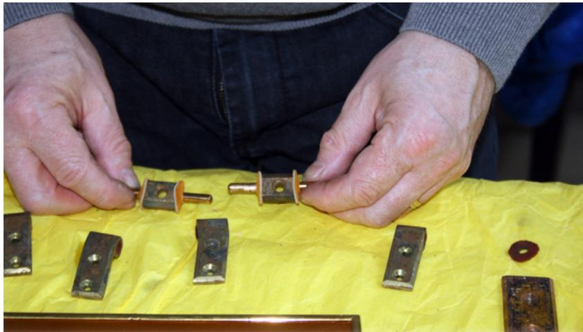
Les axes et autres pièces en laiton ou métal sont débarrassées de la rouille. Les axes de pédales sont lubrifiés soigneusement.
