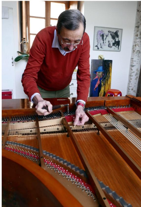
L'étape finale c'est le pinçage. Il s'agit de plusieurs accords successifs réalisés en pinçant les cordes grâce à un plectre. Il s'agit d'aller très vite pour répartir rapidement la tension et stabiliser l'accord.
