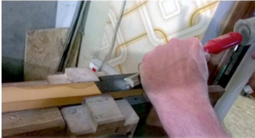
Ci-dessus : Avant tout, nous allons libérer le clavier de ses entraves en arasant les plombs gonflés par l'oxydation. Les touches de piano sont lestées avec du plomb pour compenser les différences de poids des marteaux et équilibrer les touches.
