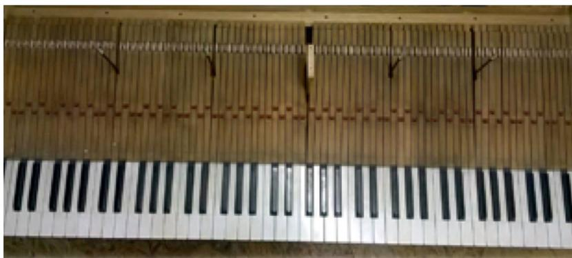
Ci-dessus, le clavier séparé de la mécanique. Il va être dépoussiéré et nettoyé. Les feutres de mortaises (en rouge) vont être remplacés ainsi que les peaux accueillant les éléments de contact avec la mécanique. Le clavier sera blanchi et repoli.
