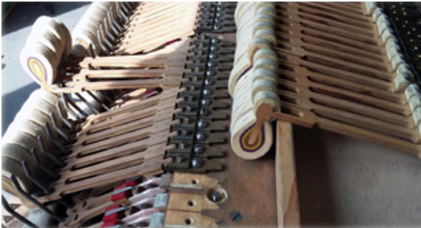
Ci-dessus : Afin de remettre en état l'ensemble des nombreuses pièces de la mécanique, tout va être démonté. Nous commençons par les marteaux car ils seront très vite expédiés dans les ateliers Desfougères à Paris pour être regarnis et remis en état.
