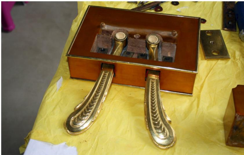
Puis les pédales sont remontées. Les peaux de contact avec la tringlerie sont remplacées à l'identique.
