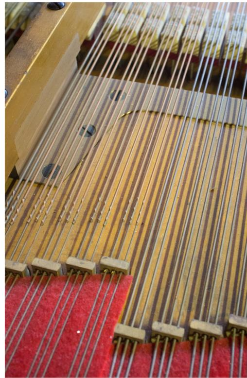
Ci-dessus : détail du cordage. Chaque corde est indépendante et accrochée par une bouclette de type « à la française » qu'il faut réaliser avec un outil spécifique. Notons sur la photo de droite les « spires » sur les cordes filées et le filage cuivre et étain. On aperçoit à travers les cordes les étouffoirs spécifiques à pression par le dessous des cordes.
