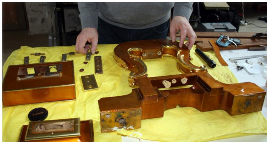
Tous les éléments de la lyre ont été démontés afin de pouvoir être revernis. Avant de les remonter, nous allons regarnir tous les passages de tringlerie et remettre tous les axes en état.
