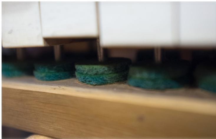
La mécanique est également complète et aucun de ses éléments n'est cassé. Tous les éléments d'usure sont à remplacer. En effet les peaux, et feutres divers sont soit particulièrement usés, soit séchés par le temps, et ne peuvent donc assurer leur fonction.
