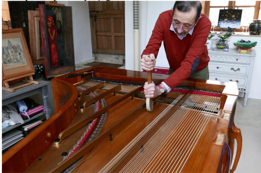
Les cordes remises en tension, on les masse afin de bien répartir la tension et permettre une tenue d'accord plus rapide.
